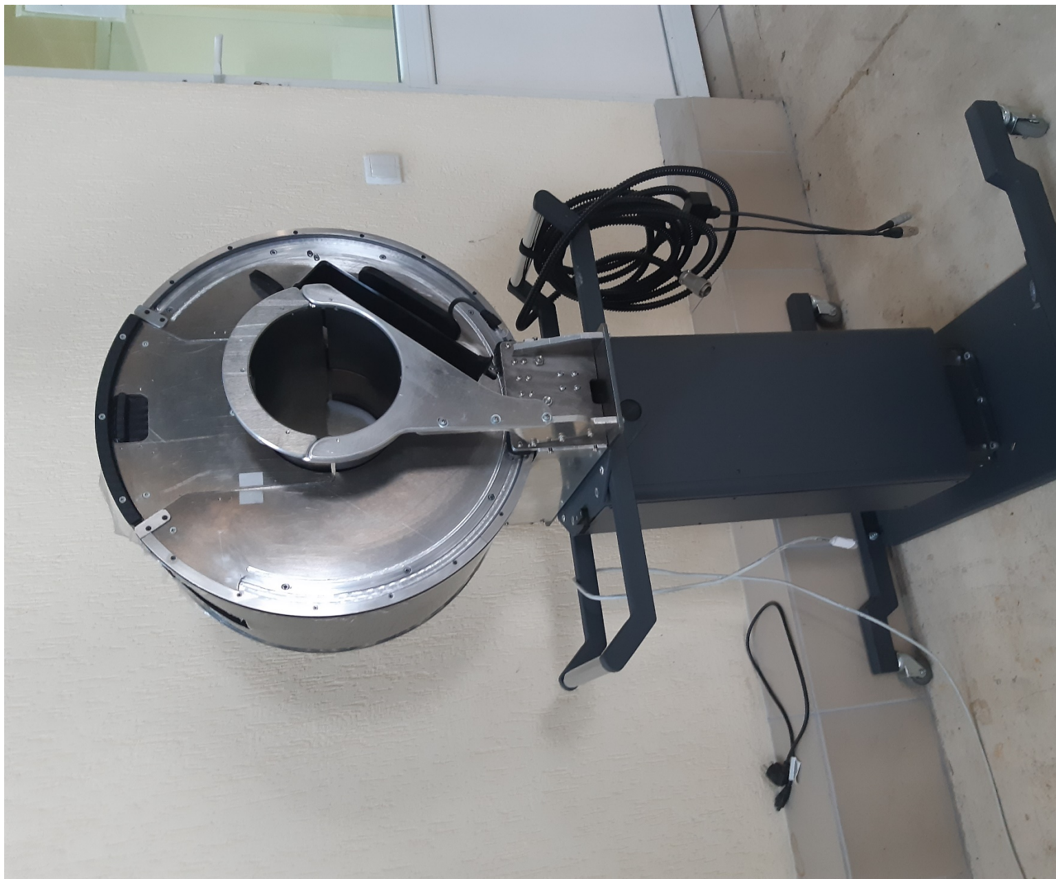
Макет механічної частини для конусно-променевого хірургічного томографа ETS
